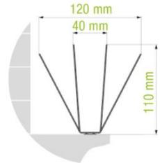
**Oisiclip** permet la fixation sur gouttière des **pics anti-oiseaux** de la gamme « **Oisipic PREMIUM** ».
